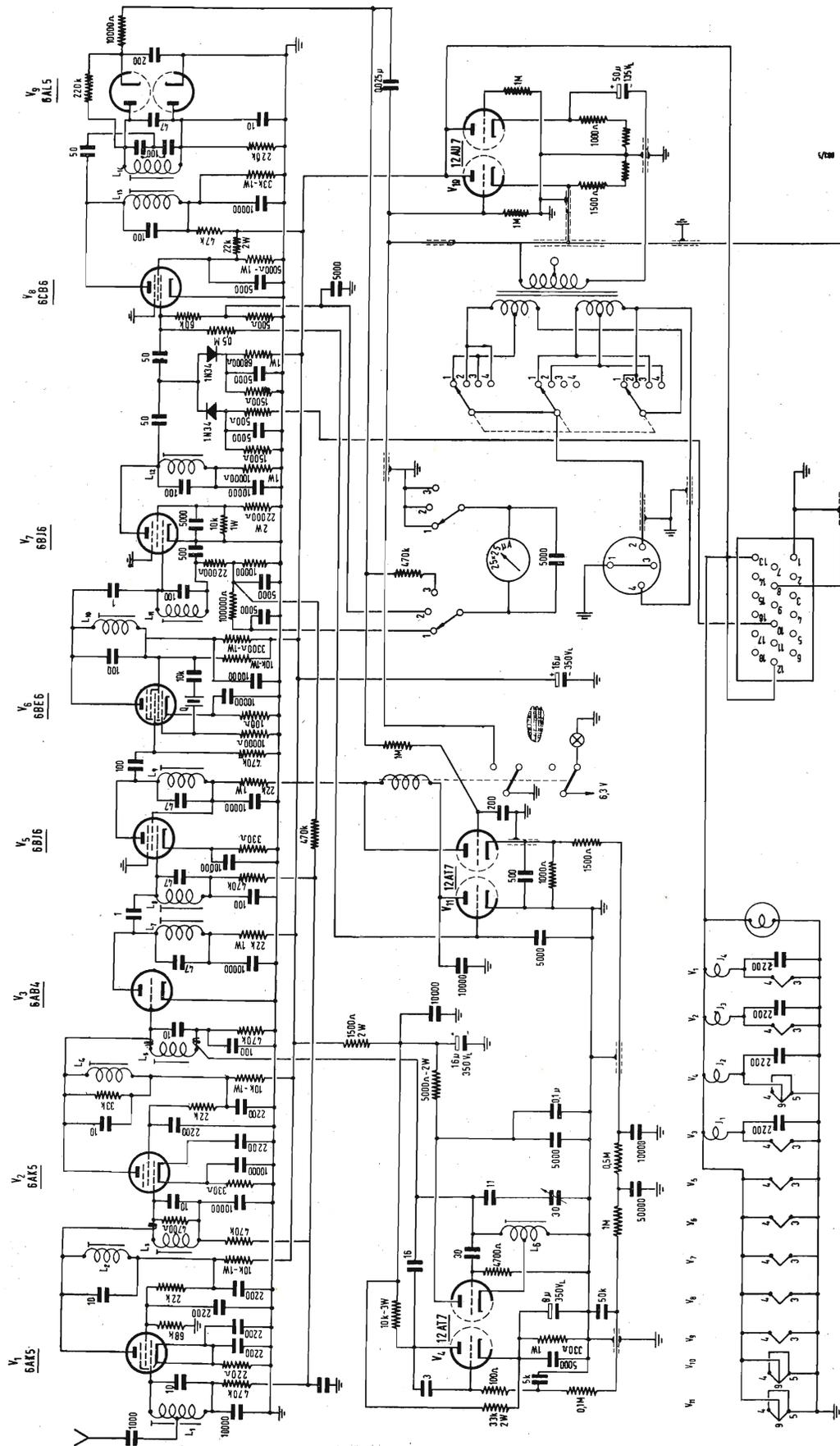
Fig. 3 - Circuito elettrico del « telemike ».
