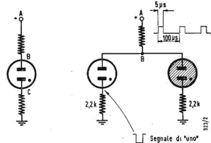
Fig. 1 - Unità base del circuito a diodo. Fig. 2 - Unità a doppio diodo.
