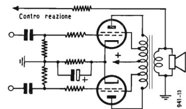
Fig. 1 - Circuito di uscita «ultralineare» a contro-reatzione sulle griglie schermo.
