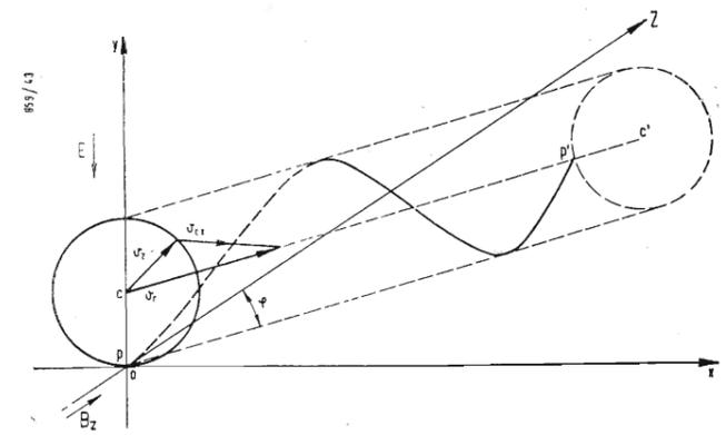
Fig. 11 - Traiettoria spaziale di un elettrone animato da un moto di traslazione lungo l'asse  $z$ .
