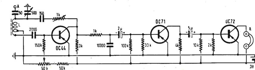
Fig. 5 - Ricevitore a reazione a tre stadi.  $L$  = nucleo ferrite  $10 \times 110$  -  $190 \mu\text{H}$ , 60 spire filo rame  $\varnothing 0,35$  mm con presa per la massa alla 10ª spira dal lato base primo transistor;  $R$  = cuffia ad altoparlante con impedenza  $Z = 500 \div 2.000 \Omega$ .
