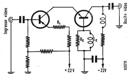
Fig. 8 - Amplificatore video sperimentale proposto nel 1953 e realizzato con transistori a punto di contatto (P.I.R.E.)
