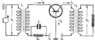
Fig. 1 - Amplificatore di un microfono con transistore con base a terra.
