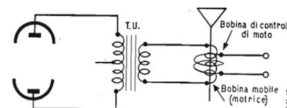
Fig. 9 - Altoparlante speciale dotato di due bobine.
