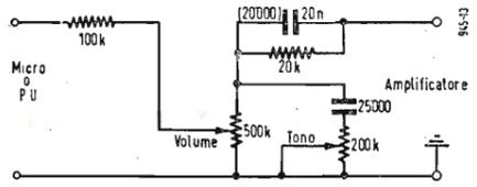
Fig. 9 - Circuito d'ingresso ad alta impedenza.
