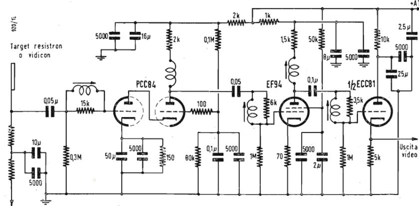
Fig. 5 - Preamplificatore video della telecamera Grundig «Fernaug».
