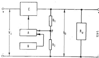
Fig. 3 - Schema a blocchi di un circuito di stabilizzazione.  $V_i$  = tensione raddrizzata non stabilizzata;  $V_o$  = tensione stabilizzata; B = elemento di riferimento; A = amplificatore; C = elemento di regolazione.
