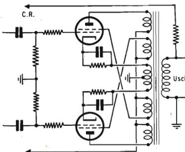
Fig. 3 - Stadio finale Me Intosh a carico distribuito sulle placche e sui catodi.
