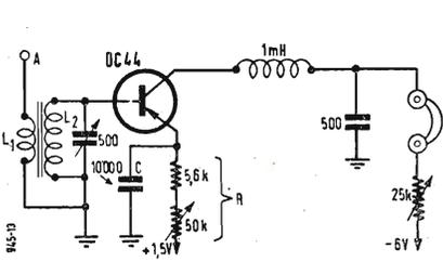
Fig. 3 - Ricevitore a super-reazione.  $L_1 - L_2$  = nucleo ferrite  $10 \times 110$ ;  $L_1$  = 17 spire rame  $\varnothing 0,35$  mm avvolte ad una estremità su  $L_2$  = 60 spire filo, come  $L_1$ .
