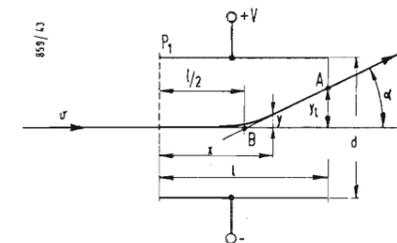
Fig. 2 - Moto elettronico in un campo elettrico uniforme diretto perpendicolarmente allo spostamento iniziale.
