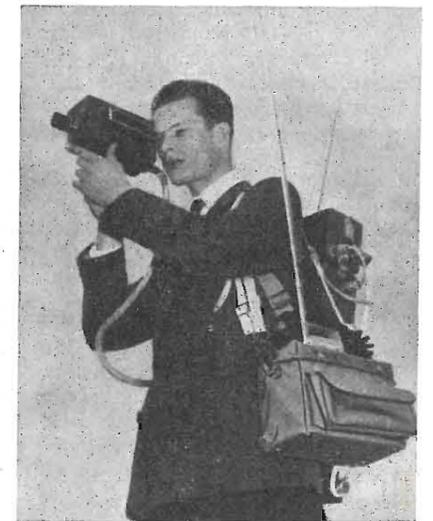
Fig. 7 - Telecamera portatile per uso reportage. Essa comprende anche un piccolo trasmettitore su ultrafrequenze.
