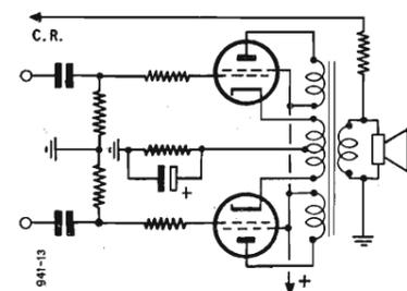
Fig. 2 - Circuito di uscita a contro-reatzione catodica.
