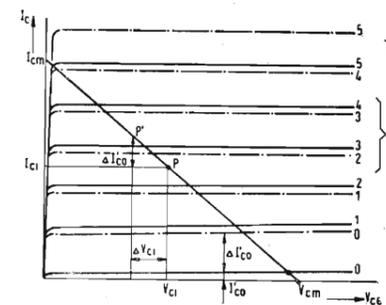
Fig. 3 - Serie di caratteristiche  $I_c - V_{ce}$  e per vari valori della corrente di base  $I_b$ . Le linee a tratto intero valgono per temperatura ambiente, le linee tratteggiate per temperatura più alta. Il punto di lavoro  $P$  è segnato sulla linea di carico.
