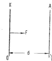
Fig. 1 - Moto elettronico in un campo elettrico uniforme diretto come lo spostamento.
