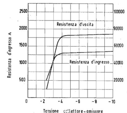
Fig. 11 - Caratteristiche medie del transistor 2N247.
