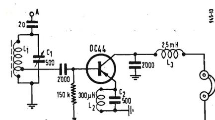
Fig. 4 - Semplice ricevitore a reazione.  $L_1$  = nucleo ferrite  $10 \times 110$ , 60 spire filo rame  $\varnothing 0,35$  mm con presa alla 10ª spira dal lato massa.
