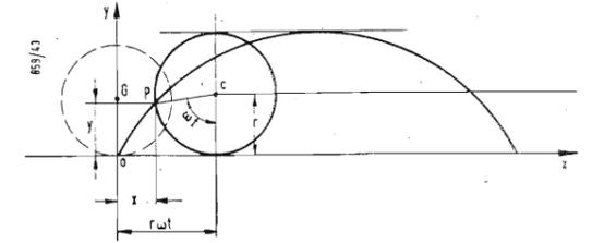
Fig. 10 - Cicloide, proiezione nel piano  $xy$  della traiettoria elettronica nel caso di fig. 9.
