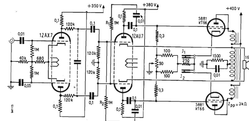
Fig. 4 - Schema elettrico di un amplificatore facente uso di reazione di tensione positiva e negativa.
