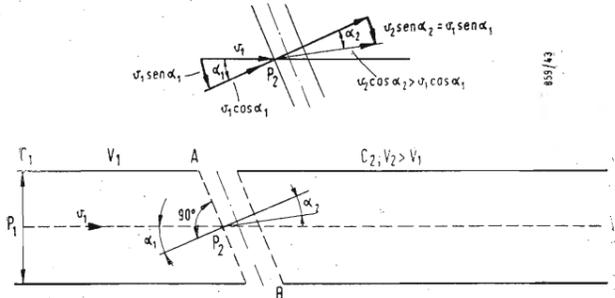
Fig. 3 - Moto elettronico in un campo elettrico uniforme formante un angolo  $\alpha$  diverso di  $\pi/2$  con la direzione dello spostamento iniziale.
