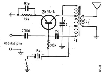
Fig. 11 - Trasmettitore autoalimentato 3,5 MHz C<sub>1</sub> - C<sub>2</sub> = 2x150 pF; L<sub>1</sub> = 44 spire filo rame Ø 0,35 mm; L<sub>2</sub> = 25 spire filo rame Ø 0,35 mm su L<sub>1</sub>; L<sub>3</sub> = 10 spire filo rame Ø 0,6 mm, avvolti su rapporto Ø 32 mm. M = microfono a bobina mobile.
