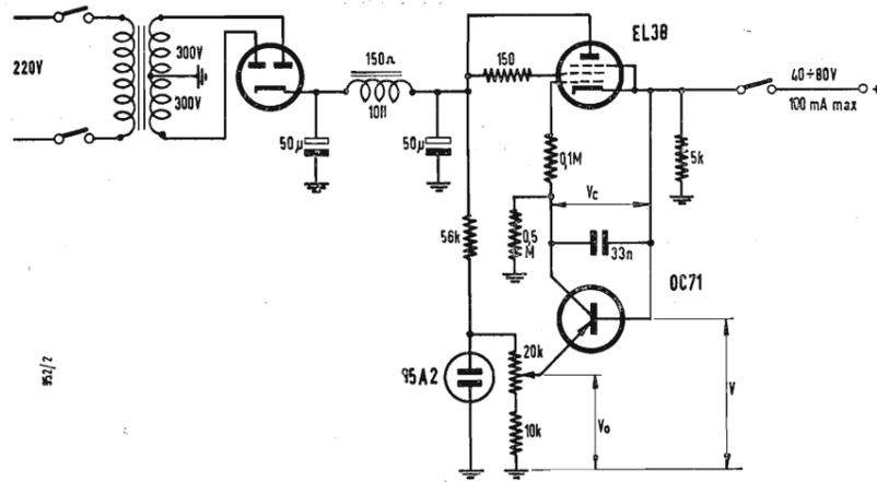
Fig. 1 - Alimentatore stabilizzato.
