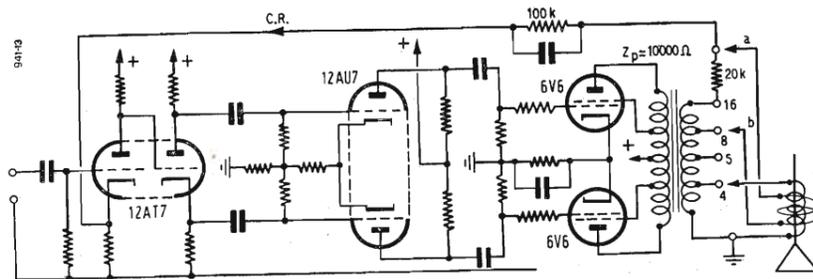
Fig. 12 - Amplificatore di tipo ultra-lineare impiegante l'altoparlante con bobina supplementare.
