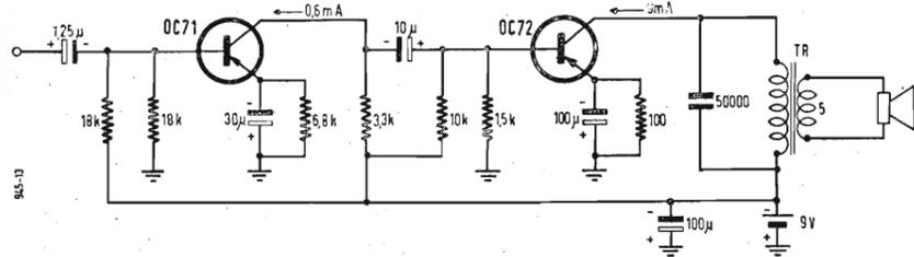
Fig. 7 - Amplificatore 50 mW. TR = impedenza ottima primaria 2.000 Ω. La polarità del condensatore di ingresso dipende dal circuito applicato ad esso. Se non esiste una componente continua (microfono, pick-up ecc.) la polarità corretta è quella indicata sullo schema. Se una componente continua è presente, di segno negativo e di valore maggiore della tensione esistente sulla base di OC71 in assenza di segnale, la polarità va invertita.
