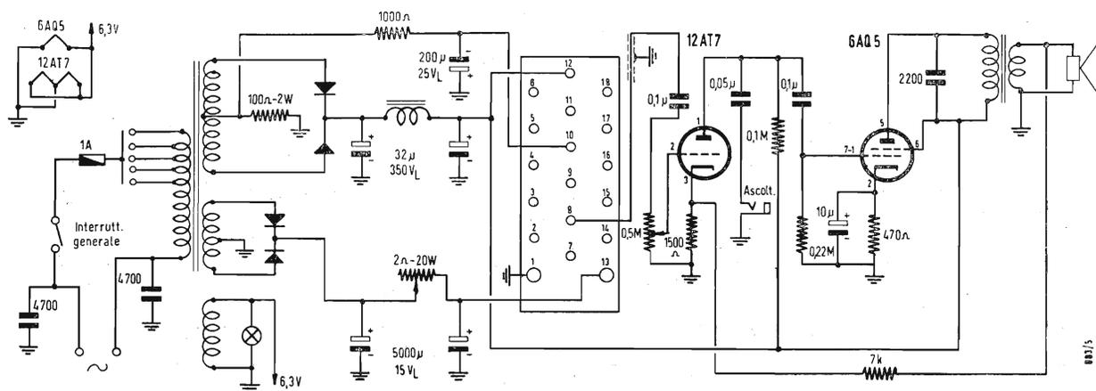
Fig. 5 - Circuito elettrico dell'alimentatore.
