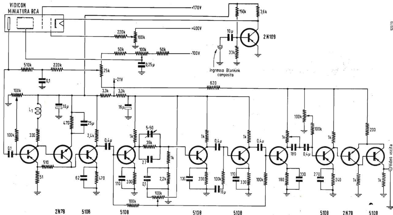
Fig. 13 - Telecamera vidicon miniatura con circuiti di deflessione esterni, realizzata sperimentalmente dalla RCA.
