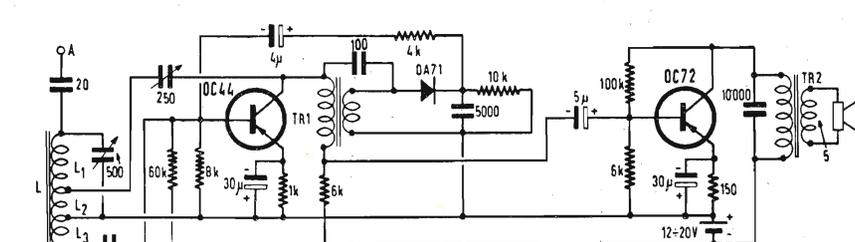
Fig. 6 - Ricevitore reflex.  $L$  = nucleo ferrite  $6 \times 110$  - 3 pezzi bobinati assieme  $240 \mu\text{H}$ ;  $L_1$  = 50 spire filo rame  $\varnothing 1$  mm;  $L_2$  = 9 spire filo rame  $\varnothing 1$  mm;  $L_3$  = 11 spire filo rame  $\varnothing 1$  mm;  $TR_1$  = impedenza primaria 10 mH, rapporto 1 : 1;  $TR_2$  = impedenza primaria ottima 3.600  $\Omega$ , rapporto 27 : 1 (per impedenza bobina mobile 5  $\Omega$ ).
