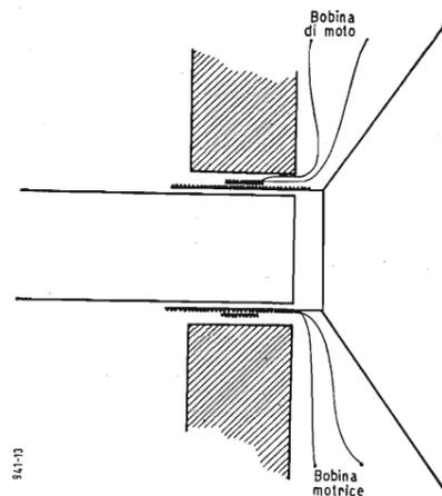
Fig. 10 - Inserzione pratica della bobina collettrice.
