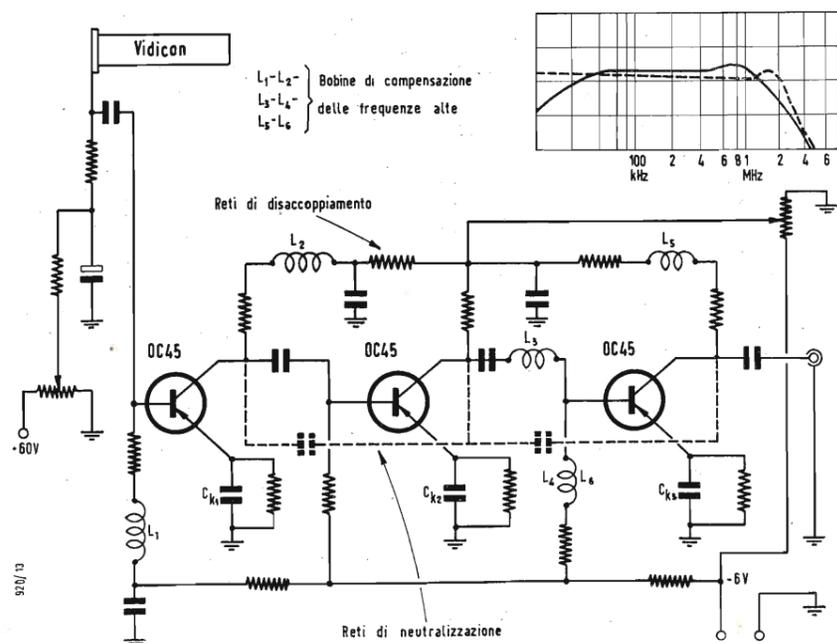
Fig. 9 - Circuito sperimentale amplificatore video di telecamera realizzato con transistori. La banda passante prevista è di 2 MHz ± 2 dB.
