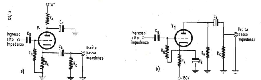
Fig. 2 - Stadi d'uscita per preamplificatori video di telecamera: a) «cathode follower», b) «anode follower». Il primo permette di ottenere un segnale a bassa impedenza di fase uguale a quello d'entrata, il secondo invece un segnale a bassa impedenza di fase opposta a quello d'entrata.
