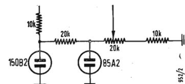
Fig. 2 - Sorgente modificata della tensione di riferimento.
