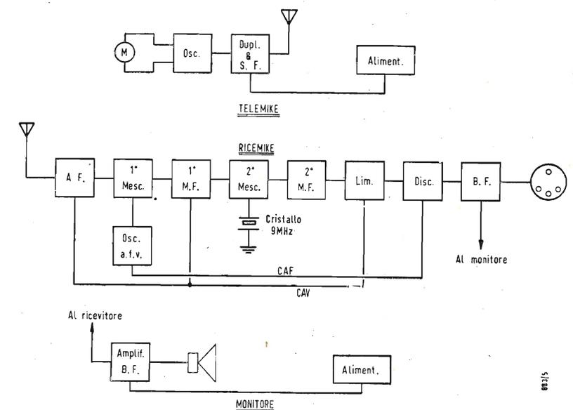
Fig. 2 - Circuiti a blocchi del « telemike », del « ricemike » e del monitor.
