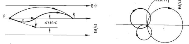
Fig. 6 - Moto elettronico in un campo magnetico formante un piccolo angolo  $\alpha$  con la direzione dello spostamento.
