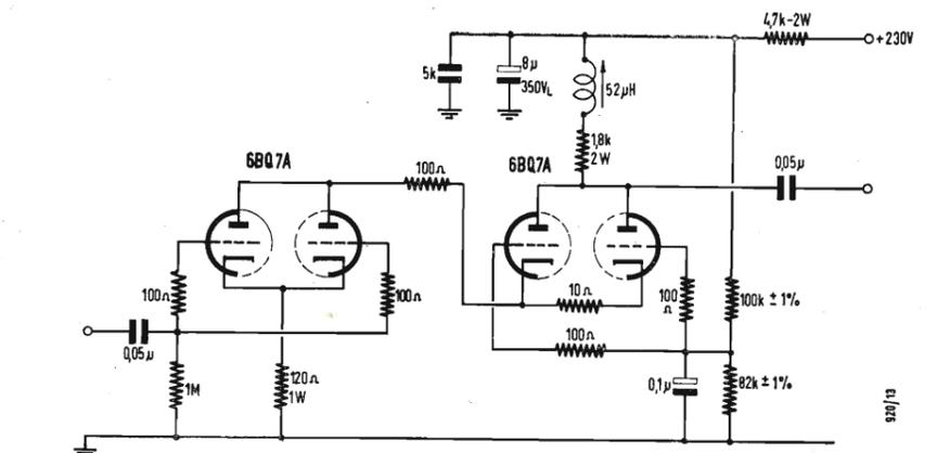
Fig. 3 - Stadio d'ingresso di preamplificatore video «cascode» con due doppi triodi 6BQ7A.
