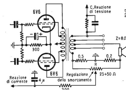
Fig. 8 - Stadio di potenza per amplificatore a smorzamento variabile.
