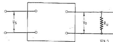
Fig. 1 - Schema a blocchi di una alimentazione. Il carico utile, rappresentato da  $R_u$ , è alimentato dalla tensione  $V_o$ . La tensione della sorgente di alimentazione (ad es. una rete a 50 Hz) è indicata con  $U_s$ .
