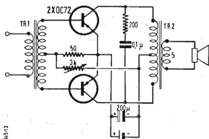
Fig. 8 - Amplificatore 0,5 W. TR<sub>1</sub>, TR<sub>2</sub> = vedi testo.
