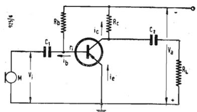
Fig. 2 - Amplificatore di un microfono con transistore con emettitore a terra.
