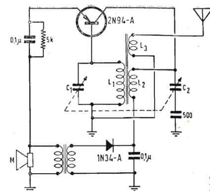
Fig. 12 - Trasmettitore miniaturizzato 3,5 MHz. C = 150 pF; L<sub>1</sub> = nucleo in ferrite 10x60, 30 spire filo rame Ø 1 mm con presa alla 70<sup>a</sup> e alla 20<sup>a</sup> spira dal lato condensatore fisso 250 pF; L<sub>2</sub> = 12 spire come L<sub>1</sub> contigue.
