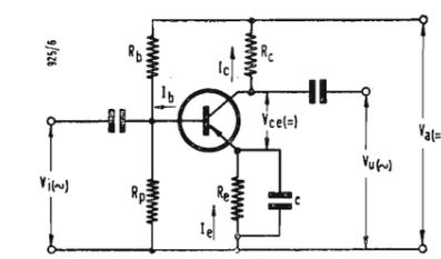
Fig. 6 - Stabilizzazione di un amplificatore con emettitore a terra, per confronto fra tensione di base e di emettitore.
