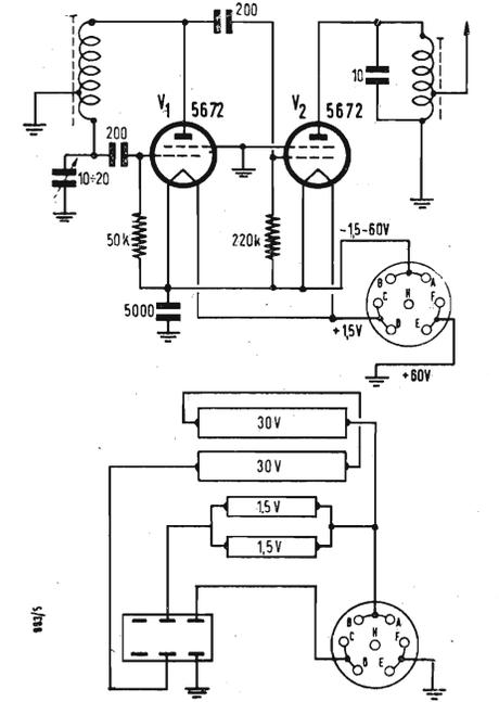
Fig. 4 - Circuito elettrico del « telemike ».
