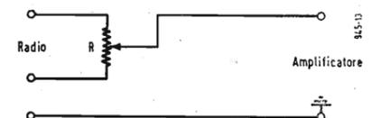
Fig. 10 - Circuito d'ingresso a bassa impedenza.
