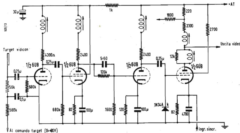
Fig. 4 - Preamplificatore video della telecamera industriale RCA «TV-Eye».
