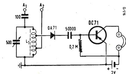
Fig. 2 - Semplice ricevitore con diodo e transistor.  $L_1$  = nucleo in ferrite  $6 \times 110$ , 3 pezzi bobinati assieme, con filo di rame smaltato  $\varnothing 1$  mm, 70 spire totali, con presa alla 10ª e 30ª spira del lato massa (Induttanza totale ca  $240 \mu\text{H}$ ).
